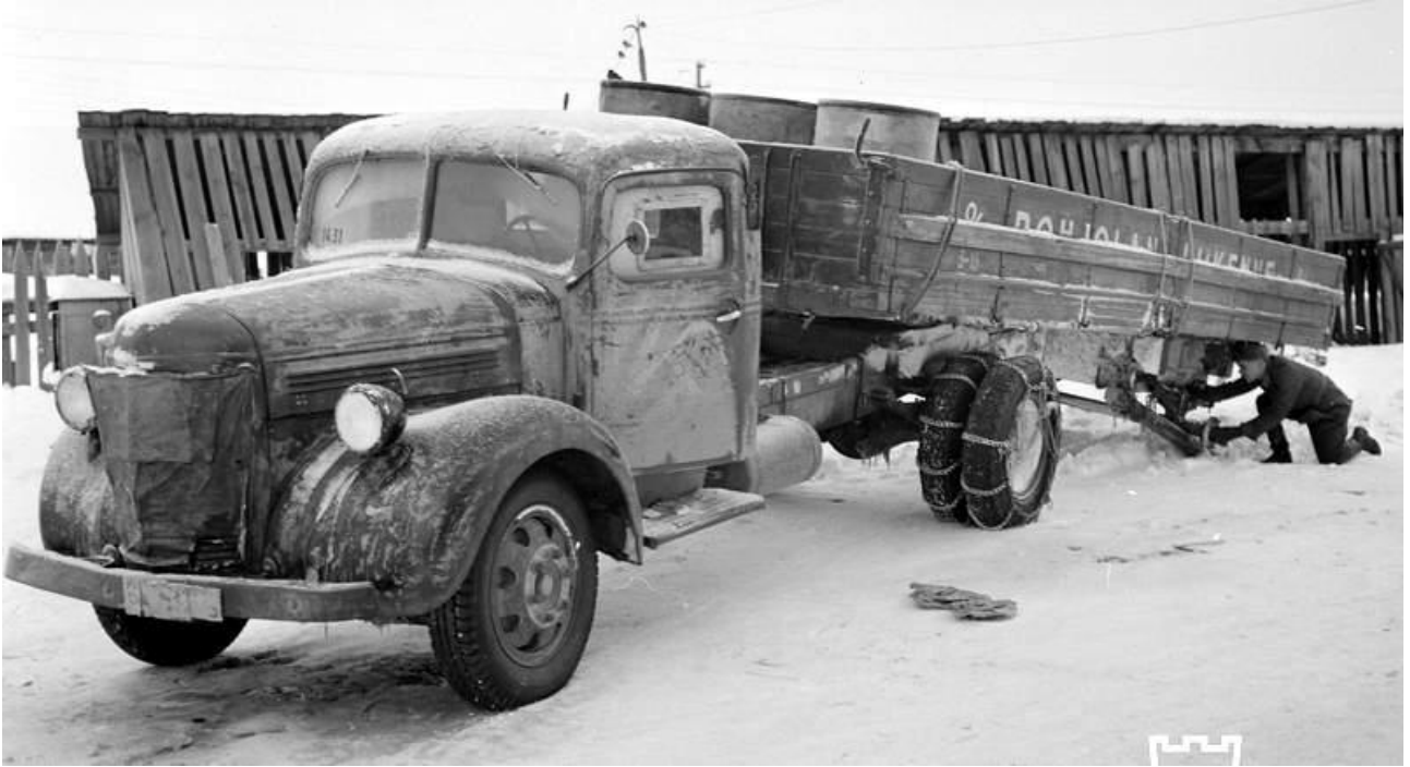
Missing wheel? Make an special opski... Oy Pohjolan Liikenne confiscated semi: 10 wheeler -2. Jos rengasta ei oo - käytetään ohjekirjan sijasta päätä ja otetaan pölkky.
