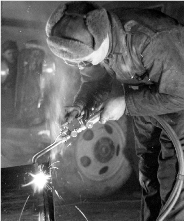
Häkäpöntön hizailua. Welding Wood stove /gas generator parts.
