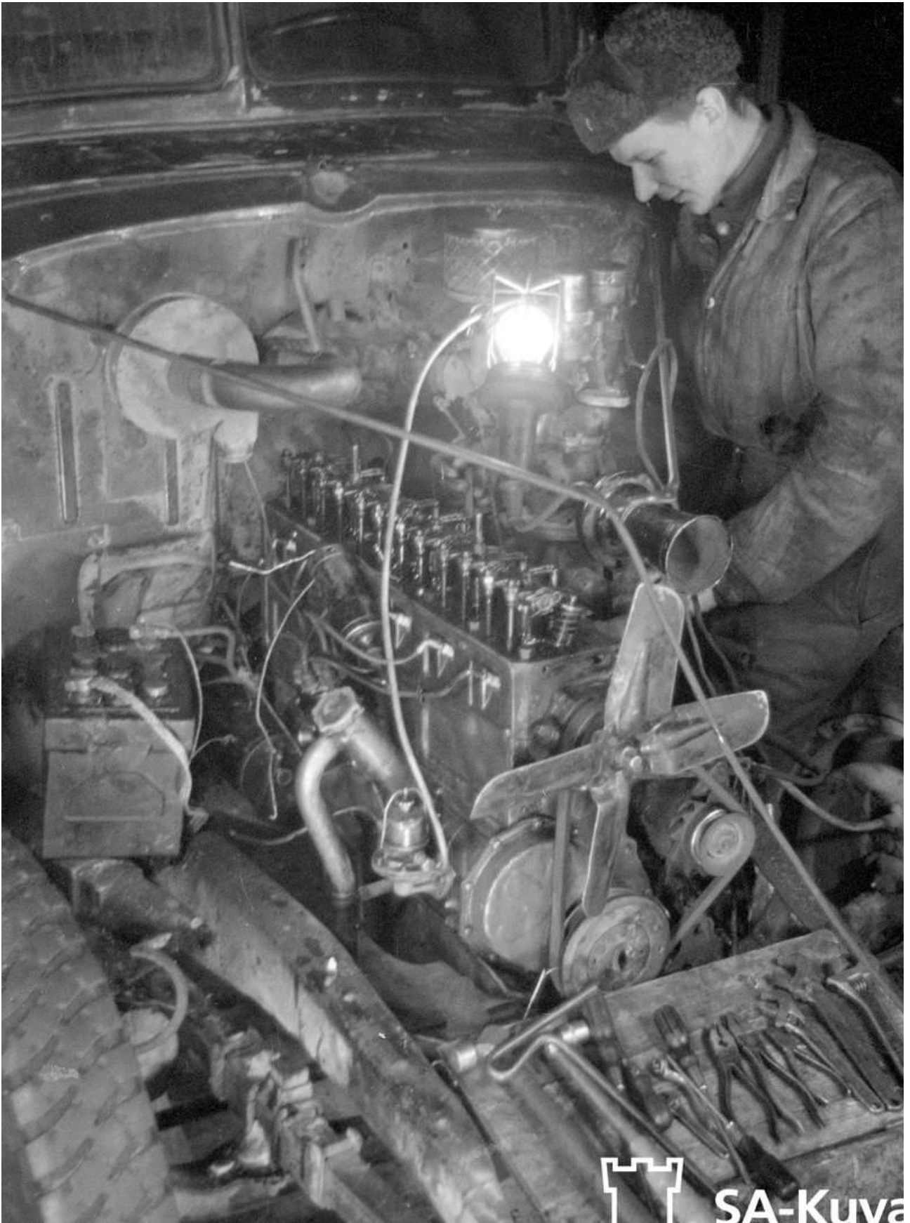
TK miehen heraldiikan tietotaito ei ylety tähän: "Moottoria korjataan. Selki 1942.02.03" Suora kuutonen ... 6V laturi työntää myrskylyhtyihin keltaista kajoa. Katti ei cadmiumia vielä kylvänyt...
