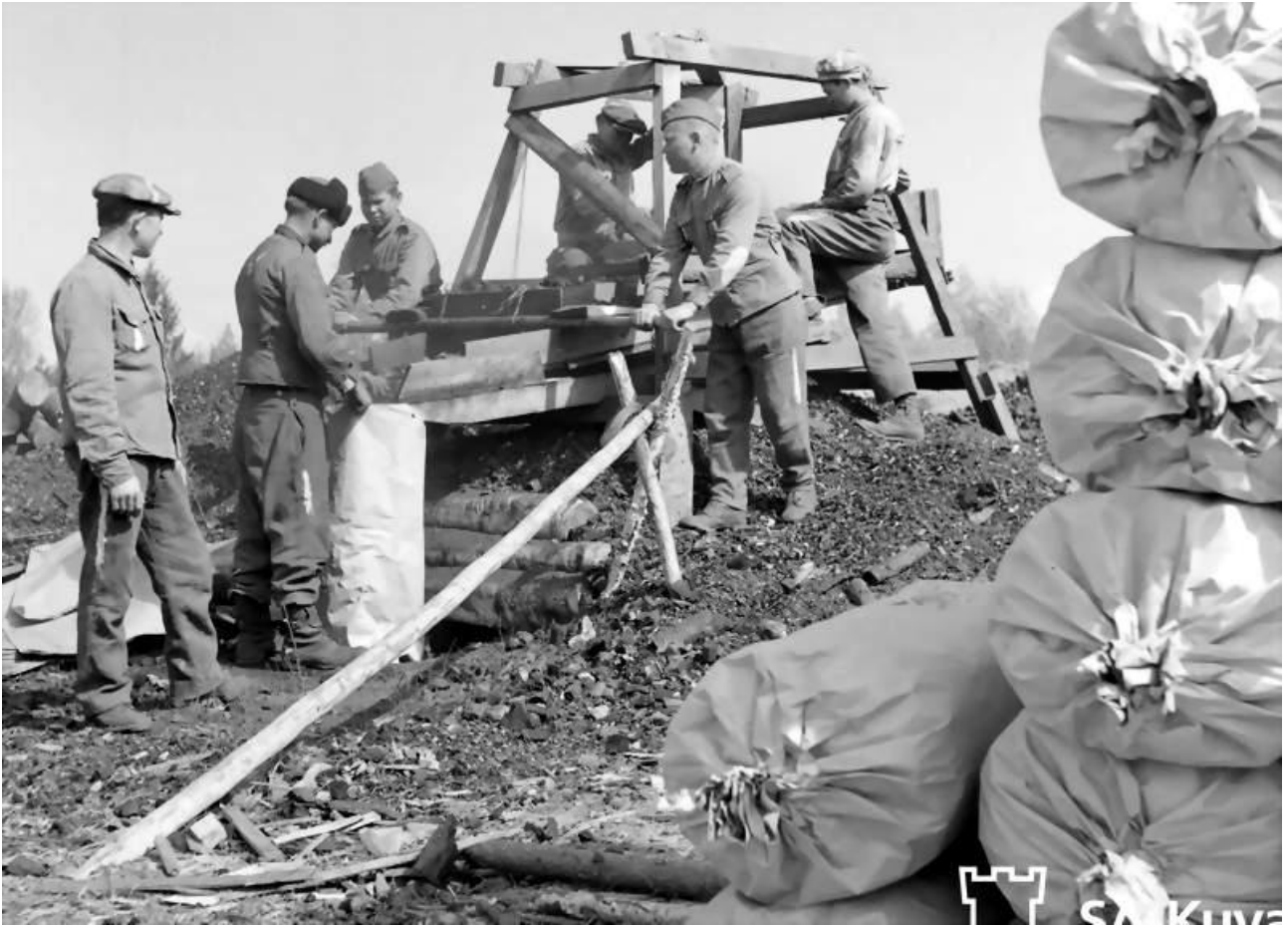
Hiiltotyömaa, josta divisioona saa tarvittavat autohiilet: Murskausmylly. Aunuksen kannas (5D:n lohko) 1943.05.27. Army depot coxing facility for truck fuel.
